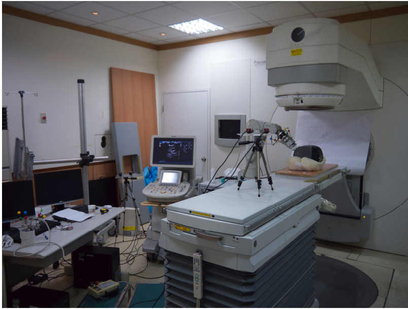
圖 2、結合由機械手臂操作之超音波，可動態即時驗證及引導放射治療之離體模式實驗
